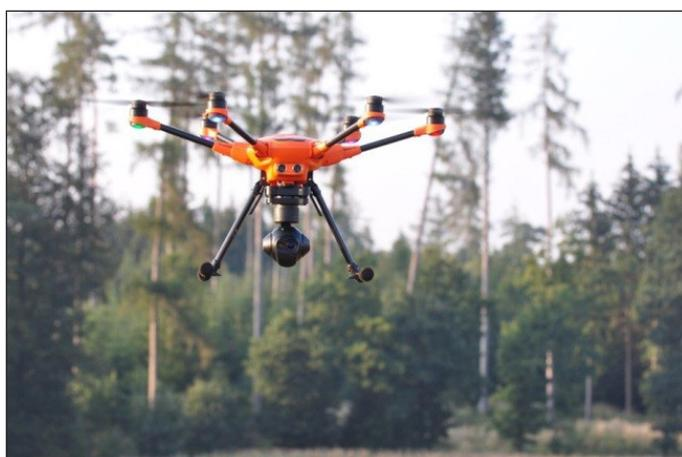
Im Rahmen der Flugvorführung schwebte die Drohne reglos über einem Hopfengarten und sendete Livebilder an einen Bildschirm. Die Wärmebildkamera lieferte in markanten Regenbogenfarben ein Wärmebild der Fläche. Zwei Personen, die dann den Bereich unter der Drohne betraten, zeichneten sich im Wärmebild gut sichtbar ab, obwohl Sie durch das Blattwerk des reifen Hopfens gut abgedeckt waren.
